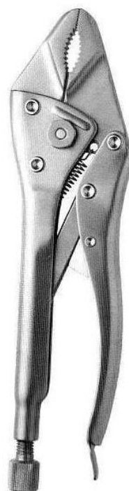
Kleszcze samozaciskowe do drutu o długości 18 cm (typu klucz francuski, żabka) do drutów o średnicy od 0,9 mm do 2,5 mm. Wykonane ze stali chirurgicznej, autoklawowalne
